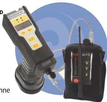
*Ceinture-pont SAFECOM (Connexion sécuritaire)<sup>MD</sup> muni d'une interface de détecteur HAZMATCAD<sup>MD</sup>*
