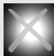
Présence d'un point lumineux central : éblouissement
