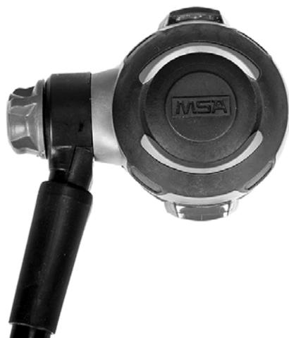
Le régulateur G1 monté sur le masque est un régulateur de pression à la demande, lequel sert à maintenir une pression positive dans la pièce faciale lorsque l'APRIA est utilisé et fonctionne normalement. Le régulateur à pression positive a pour rôle d'abaisser davantage la pression provenant du détenteur afin d'amener de l'air respirable à l'utilisateur.
