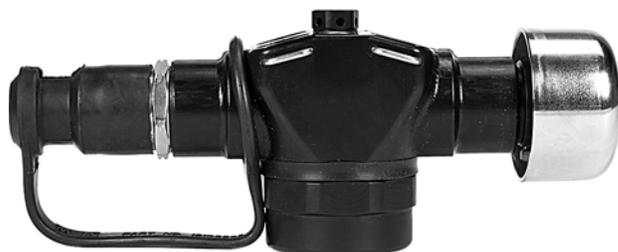
Le détendeur a pour rôle de réduire la pression en bouteille à un niveau de pression intermédiaire, laquelle est abaissée de nouveau par l'action du régulateur à une pression confortable pour la respiration. Le détendeur incorpore une conception à sécurité intégrée qui garantit l'écoulement d'air vers l'utilisateur en cas de défaillance du dispositif réducteur de pression.
