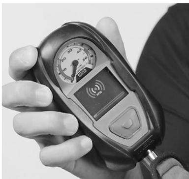
(2) Quand l'écran fait apparaître l'icône de la pile, appuyer sur le bouton d'ALARME, et le symbole RFID s'affichera.
