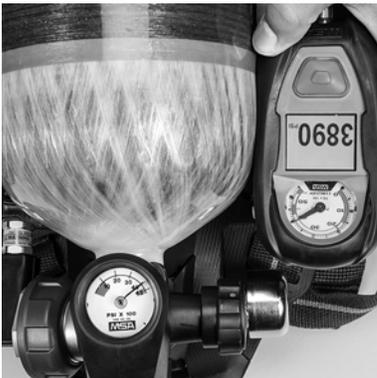
Plus aucun écoulement d'air provenant du régulateur ne devrait être constaté. Si de l'air s'écoule, répéter les étapes 9, 10 et 11 précédentes.
