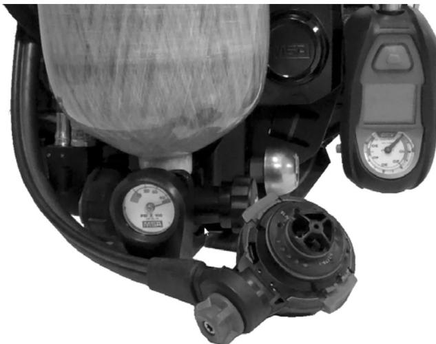
Lorsqu'on met à l'épreuve le module de commande, il faut déposer le module de commande à plat et vérifier la lumière blanche qui illumine le manomètre, puis comparer la valeur d'affichage graphique à celle du manomètre analogique afin de s'assurer que leur différence ne dépasse pas 5% par rapport à la pression en bouteille (soit 110 pour 2216 psi, soit 225 pour 4500 psi).
