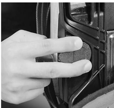
(3) Placer l'étiquette d'identification sur le côté utilisateur de la plaque dorsale, côté droit du module d'alimentation.
