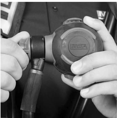
Vérifier le bon fonctionnement du système de dérivation du régulateur.
