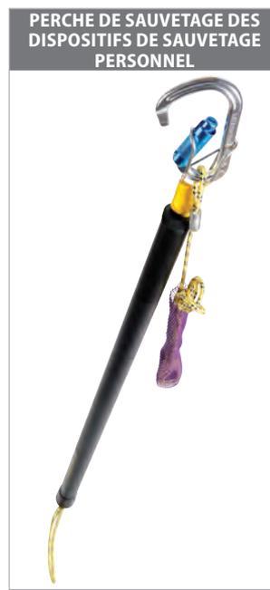
Conçue pour être utilisée par un tiers. Si l'utilisateur est incapable d'effectuer un sauvetage individuel, un tiers peut activer le deuxième mécanisme intégré de déclenchement de la descente du dispositif de sauvetage personnel Latchways. La longueur totale de la perche est de 2,7 pi (0,8 m) lorsque rétractée et de 11,1 pi (3,4 m) une fois déployée.
